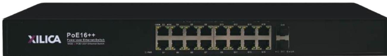
POE16++ 系列是全千兆 bt PoE交换机，具备 16 个 10/100/1000M 自适应RJ45端口+2 个 1000M SFP光口插槽,其中 1-16 口支持超大功率71W POE输出，并且向下兼容 IEEE 802.3af/at PoE标准，单端口 PoE 功率高达95W。作为PoE供电设备，能自动检测识别符合标准的受电设备并通过网线为其供电。可通过网线为 PTZ 网络球机，大功率无线AP,大功率网络多媒体音箱，大功率 POE 照明等终端提供稳定、安全、可靠电力输出和数据传输，满足对高密度PoE供电有需求的网络环境，适合酒店、校园、园区、商超、景区、厂区宿舍及 SMB 中小型企业组建经济高效的网络。
